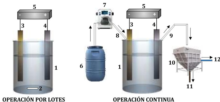
**Figura 3.** Diagrama esquemático de la EC operada por lotes y en continuo. (1) Celda electroquímica; (2) agitador magnético; (3) cátodo; (4) ánodo; (5) fuente de poder; (6) depósito de almacenaje; (7) bomba; (8) influente; (9) salida de agua tratada; (10) tanque de asentamiento; (11) salida de lodos; (12) efluente tratado (Elaboración propia adaptada de Mousazadeh, 2021)
